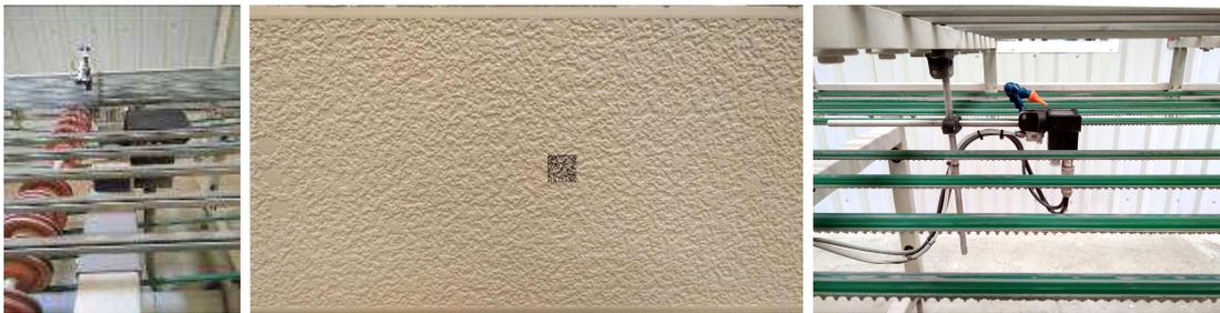
Figura 2. De izquierda a derecha: cabezal de impresión para el marcado de piezas, pieza codificada y cámara de detección.
