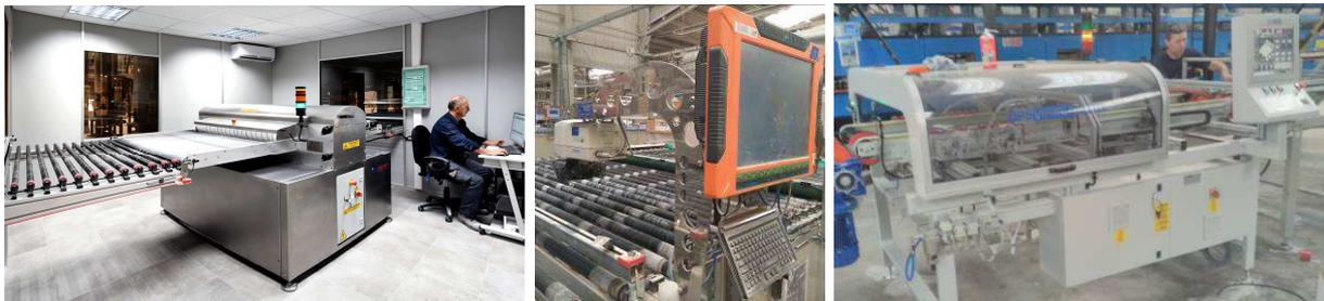
Figura 4. Dispositivos de control incorporados. De izq. a der.: Densexplorer® control de densidad aparente, control automático del prensado y control dimensional a salida de horno.
